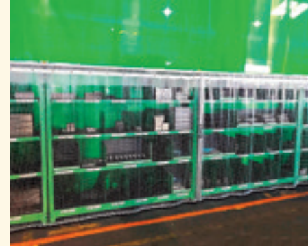
製品棚 防塵 ビニールシート、D30レール、間仕切ポール使用
