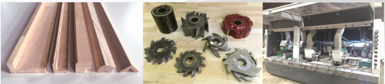
設備：モルダー 1台、ワイドベルトサンダー 1台、ラッピング加工機 4台、ダブルジャンピングソー 1台、ジャンピングソー 2台、巾木製造ライン 1ライン
