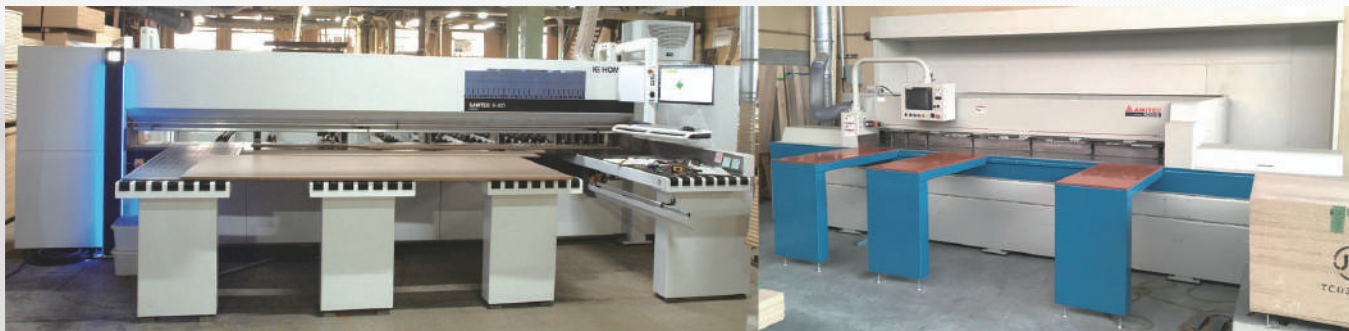
設備：ランニングソー（4m）2 基、（3m）1 基
