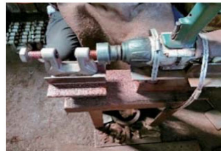
③ボルト回転確認・注油
