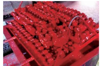
④防錆処理
