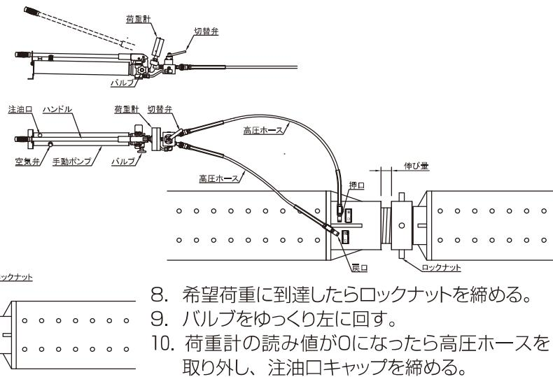
8. 希望荷重に到達したらロックナットを締める。
