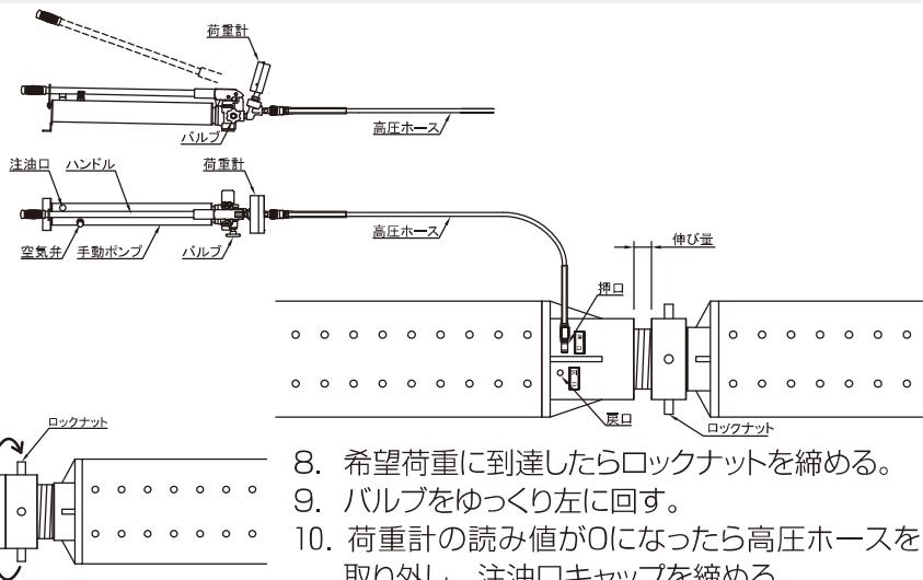
8. 希望荷重に到達したらロックナットを締める。
