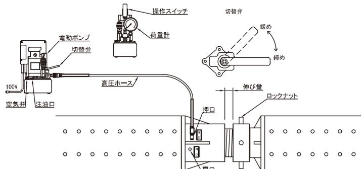
7. 希望荷重に到達したらロックナットを締める。
