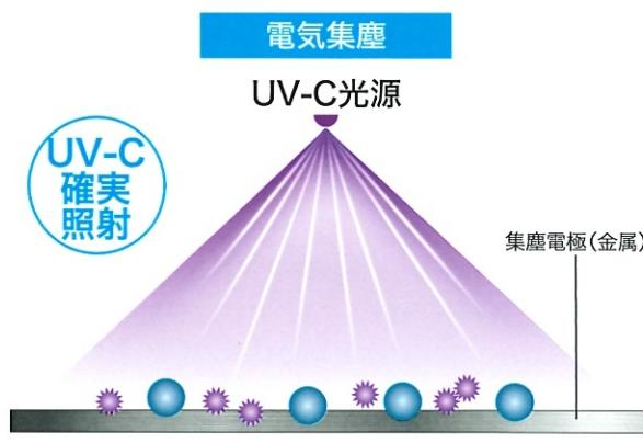
集塵電極表面のウイルスに対し深紫外線UV-Cを確実に照射できます
