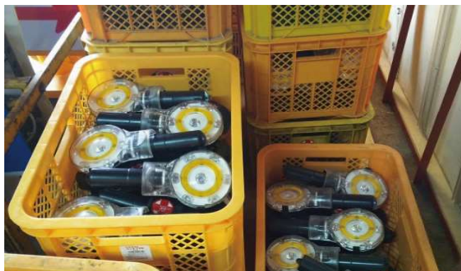
■ 工事用保安灯
