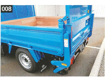
衝撃・ぐらつきを抑えるブレーキバルブを装備しています。
