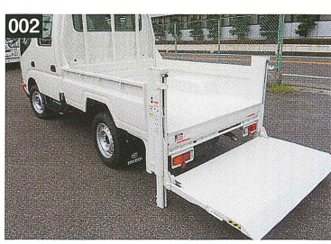
背の高い積荷や、揺れを嫌う積荷に最適な垂直昇降式です。
