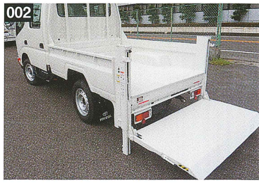
背の高い積荷や、揺れを嫌う積荷に最適な垂直昇降式です。
