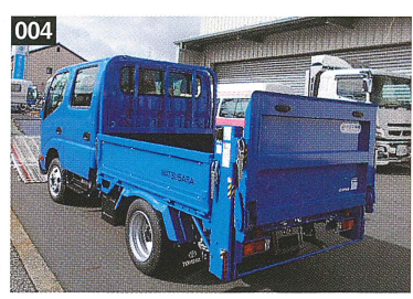
サイドの支柱が短く、作業がしやすいコンパクトなリフトです。
