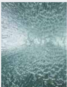
強化合わせガラス（4mm+4mm）ガラス片も飛散せず貫通もしない
