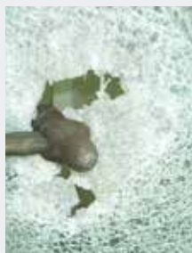
強化合わせガラス（4mm+4mm）数十回連打して貫通した所
