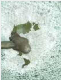
強化合わせガラス（4mm+4mm）数十回連打して貫通した所
