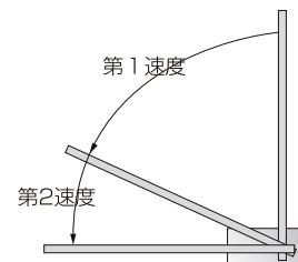
※閉扉速度は速度調整弁にて開扉角度90°から閉扉まで5秒～7秒(適正速度)の間で調整してください。
