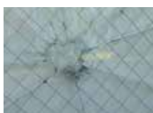
網入り板ガラス 衝撃物は網を破って貫通します。
