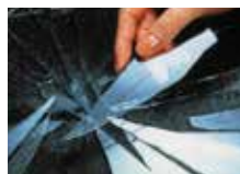
フロート板ガラス 破損すると鋭利なガラス破片としてたいへん危険です。
