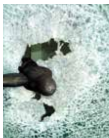
強化合わせガラス(4mm+4mm) 数十回打って貫通した所
