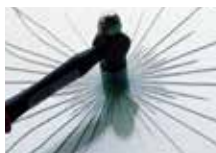
ラミハード(フロート合わせガラス) 飛散・貫通がほとんどなく中間の特殊フィルムを厚くすることで、耐貫通性もより大きくなります。
