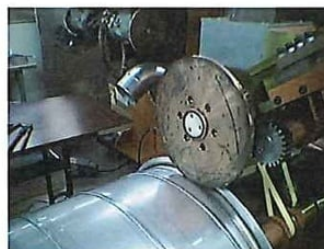
スパイラル管フランジ部溶接
