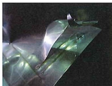
50ミクロンのシーム溶接
