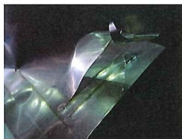
50ミクロンのシーム溶接
