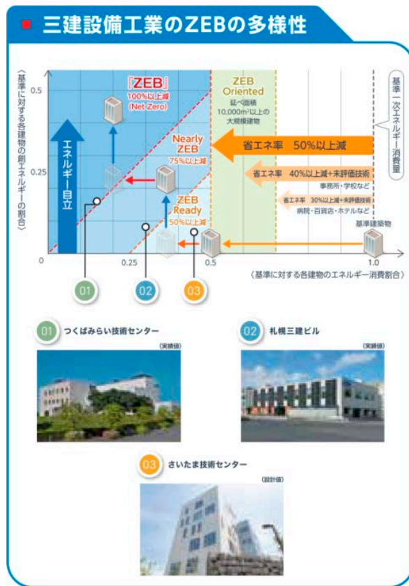
図42 三建設備工業株式会社のZEBの多様性 （三建設備工業株式会社より資料提供）
